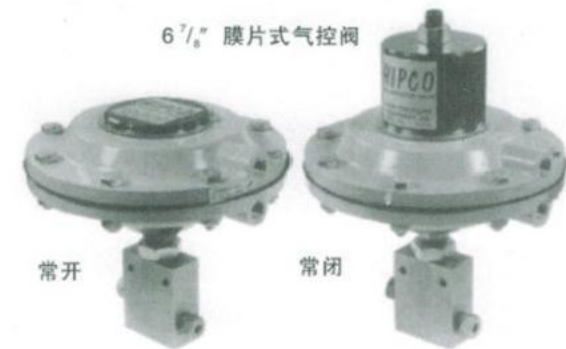
膜片式常开气控阀(弹簧打开/供气关闭)
